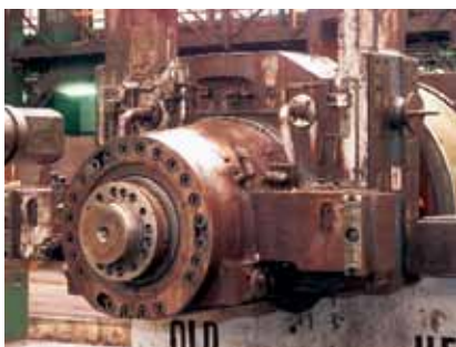
轴承座上的止推环比先前的方法创造出更高的预紧力，甚至可以吸收峰值载荷。辊颈可持久使用，生产能运行顺利。
