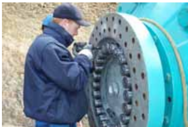
风机齿轮箱的凸缘联轴器。一个整合超级螺栓技术的膨胀螺栓用于传递巨大的扭矩。这个解决方案也是紧凑的并不增加更多的重量，这是符合要求。
