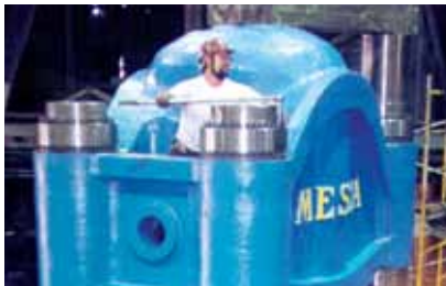
8个超级螺栓立柱螺母只需要12个工时安装 对比两个半全天的立柱加热安装。
