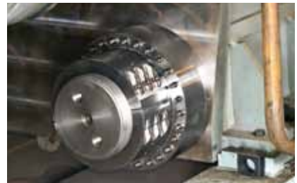
对开螺母止推环是超级螺栓所做的一个客户定制产品，与大压机立柱上的其他大螺纹紧固件相比，更容易安装和拆卸。
