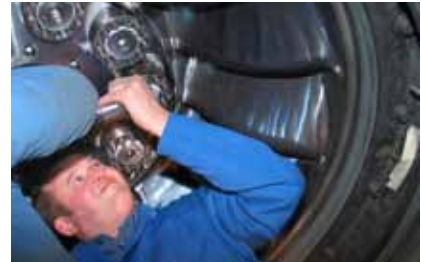
有了超级螺栓张紧器，在密闭空间比较棘手的位置上的连接件也能够拧紧。这个Francis车轮有常规维护要求，已用MJTs来连接轮子和轴。
