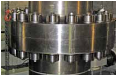
超级螺栓膨胀螺栓理想地适用于联轴器，这里可见在发电厂的Francis型泵/发电机联轴器上。
