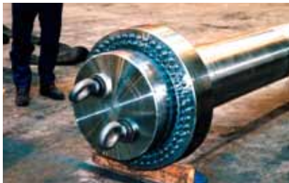
世界上最大的螺栓型多顶推张紧器 直径28" x 长40' (直径711.2 mm长12.2 m)。这用于一个大型液压锻压机。
