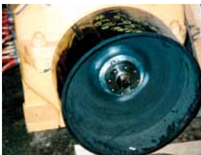
超级螺栓轧机电动机螺母是特殊的防松螺母，设计来锁住制动轮，联轴器和皮带轮到轧机电动机上。可以直接替代发动机工厂提供的螺母。
