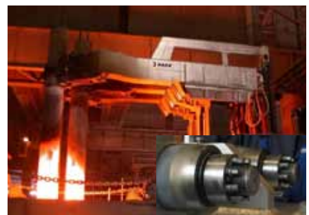
电弧炉电极臂装配。使用MJT，可以实现高预紧力用来抵抗作用于电弧炉电极臂上的极端振动。
